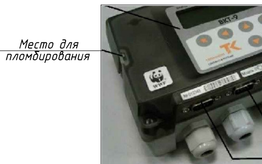
Схема пломбирования тепловычислителя
