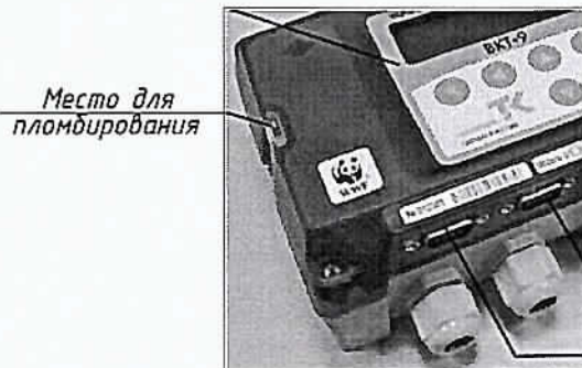
Схема пломбирования тепловычислителя
