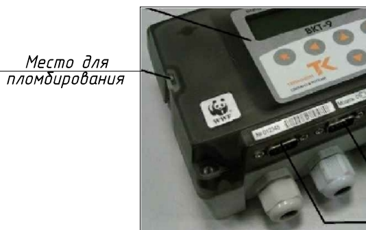
Схема пломбирования тепловычислителя
