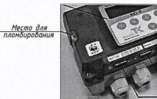
Схема пломбирования тепловычислителя
