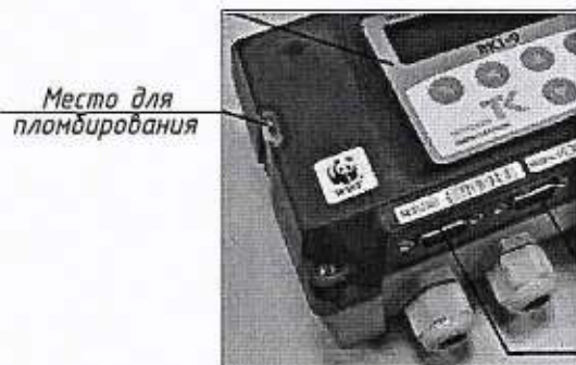
Схема пломбирования тепловычислителя
