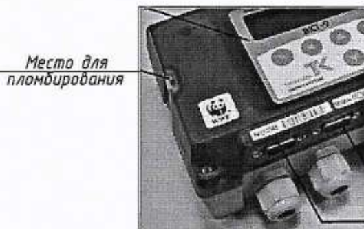
Схема пломбирования тепловычислителя
