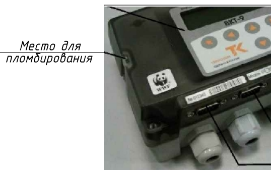
Схема пломбирования тепловычислителя
