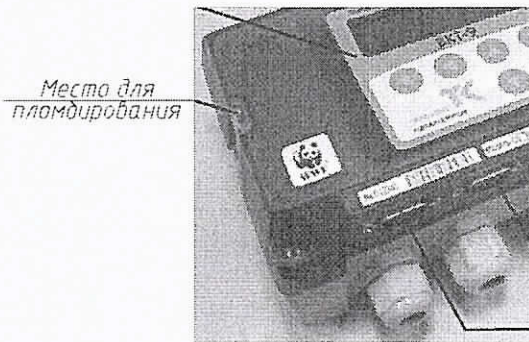
Схема пломбирования тепловычислителя
