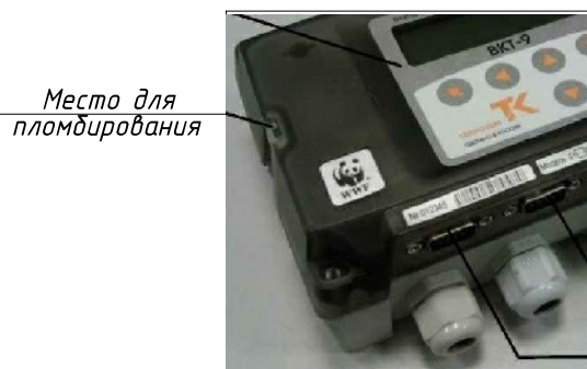
Схема пломбирования тепловычислителя
