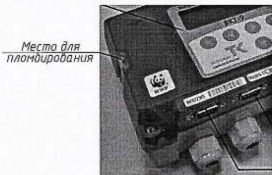
Схема пломбирования тепловычислителя
