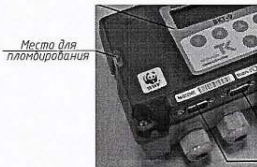
Схема пломбирования тепловычислителя
