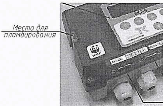
Схема пломбирования тепловычислителя
