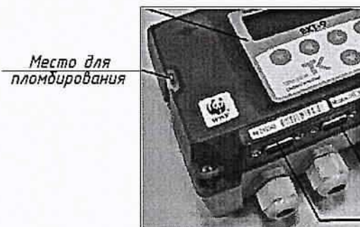
Схема пломбирования тепловычислителя
